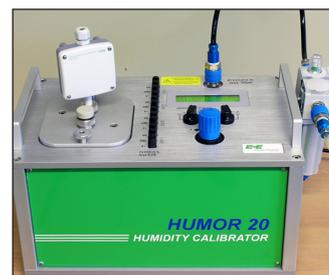
1. Placer un couvercle de chambre de mesure adapté (observer la position et le diamètre du presse étoupe) puis serrer manuellement les deux écrous moletés. S'il est toujours en place, enlever le joint torique utilisé pour le couvercle en plexiglas.
