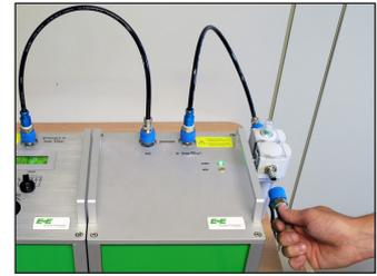
Tourner la molette de réglage d'humidité sur la droite jusqu'à la butée (sens horaire).
