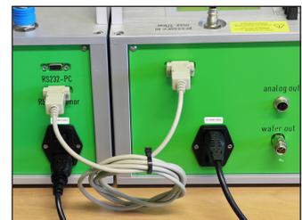
Etablir une connexion numérique du kit d'automatisation avec le PC ou un portable.
