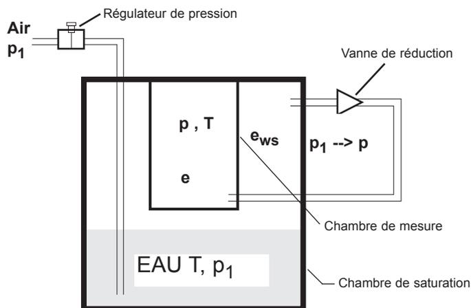
Schema d'un réacteur à deux pressions
