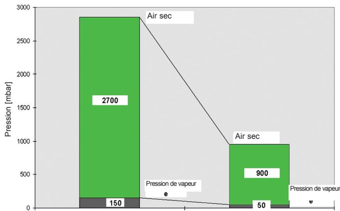
L'air ou l'azote est introduit, à une pression  $p_1$ , dans la chambre 1 puis humidifié.
