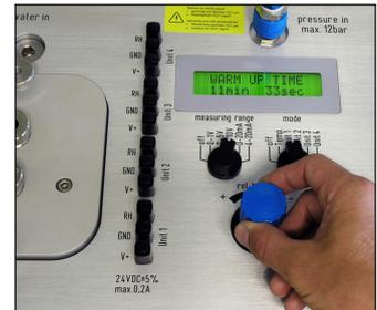
Ouvrir le récipient d'eau. Le temps de chauffage peut être ignoré. Dévisser le bouchon à l'aide de la clé Allen fournie.
