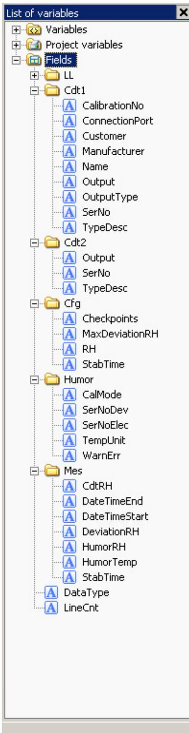
Champs: Leur contenu peut être inséré dans des tableaux dynamiques du protocole de mesure
