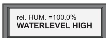
Le niveau de remplissage maximum d'eau distillée (désionisée) a été dépassé.
