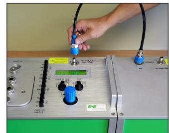
Placer le séparateur d'huile à l'aide de l'équerre de fixation prévue sur le côté du kit d'automatisation et établir la connexion avec l'entrée "Pressure in".
