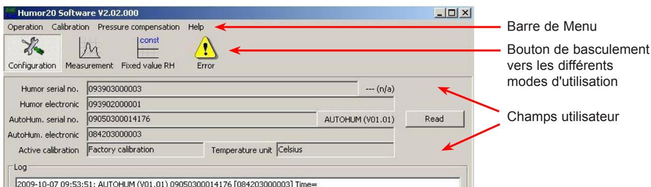
Le lancement du logiciel permet d'atteindre automatiquement le mode de configuration. L'ensemble des données concernant le numéro de série, le statut de l'HUMOR 20 et du kit d'automatisation sont alors indiqués.
