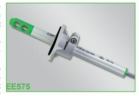
Der EE575 kann schnell und einfach montiert werden. Durch einen Führungssteg am Fühlerrohr und dem dazu passenden Montageflansch ist die Fühlerausrichtung vorgegeben. Mit dem Montageflansch kann die Eintauchtiefe stufenlos eingestellt werden.
