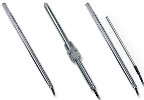
Bauformen der abgesetzten Fühler
