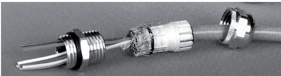
Das Schirmgeflecht ist über den Kunststoffeinsatz der Kabelverschraubung zurückzustülpen. Durch die Einführung des Kunststoffeinsatzes wird das Schirmgeflecht an die Innenwand des metallischen Teiles gedrückt.
